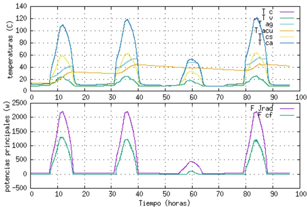
Figura 2. SIMULACIÓN BASE: Temperaturas y potencias principales. Las temperaturas de cada curva son las del nodo del diagrama denominado de igual manera.  $J_{rad}$  es la radiación efectiva en el absorbedor.  $J_{cf}$  es la potencia que ingresa al acumulador.
