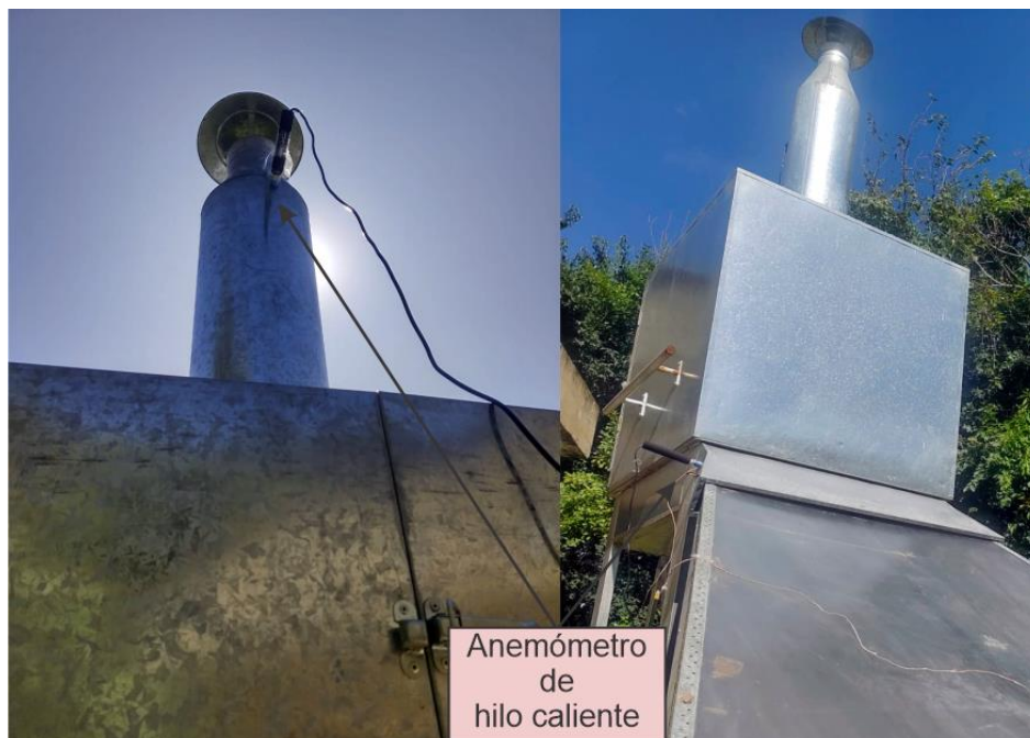
Figura 5.10. Ubicación del anemómetro de hilo caliente para medición de velocidad exterior. Derecha: a la salida del colector solar de aire, Izquierda: a la salida de la cámara de secado.
