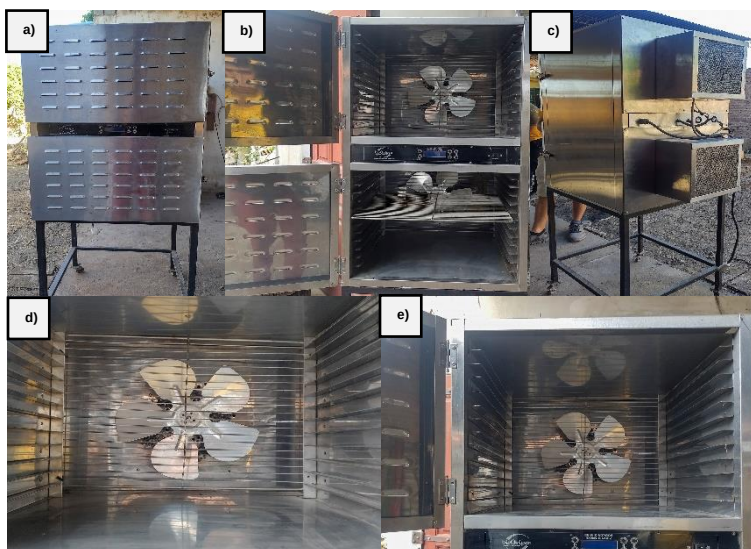
Figura 3.6. Detalle de los hornos eléctricos utilizados por la agrupación “YPA IVI” para deshidratación de alimentos. a), b) y c) detalles del exterior, d) y e) detalles del interior.
