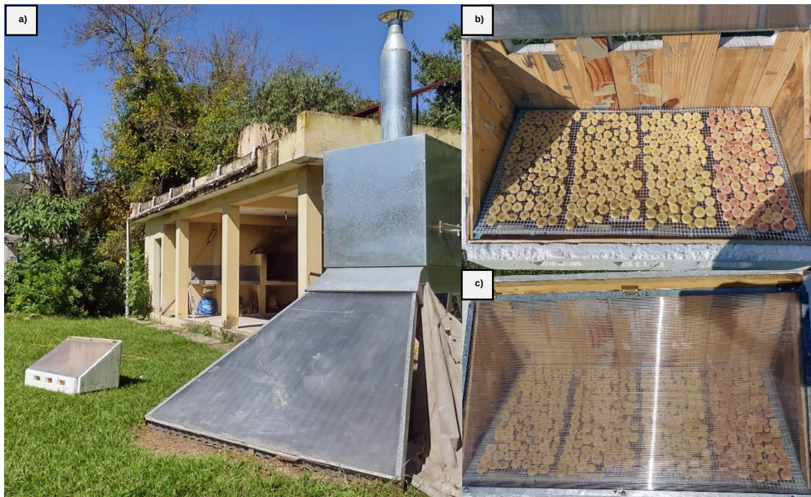
Figura 6.2. a) Disposición del secador tipo caja al lado del equipo indirecto, ambos con la misma orientación. b) detalle de la bandeja cargada con las bananas pretratadas. c) Detalle del secador tipo caja con la cubierta de policarbonato cerrada.
