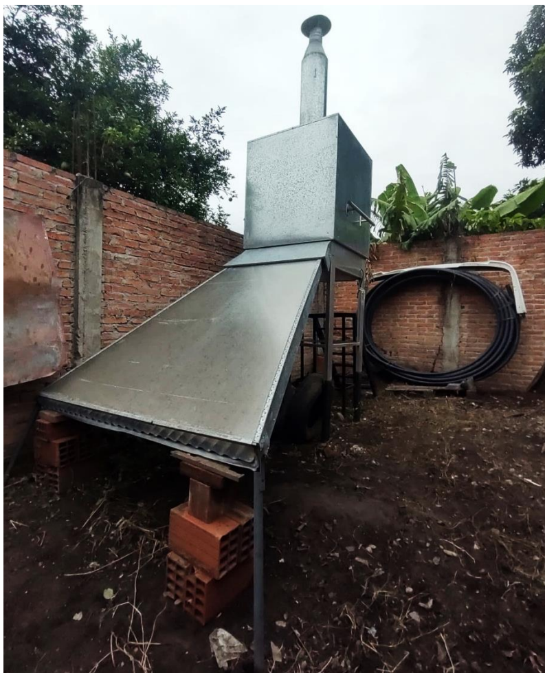
Figura 8.4. Equipo levantado para mejor incidencia del sol. Atrás se ve en negro la escalera construida para mejor acceso a la cámara de secado.
