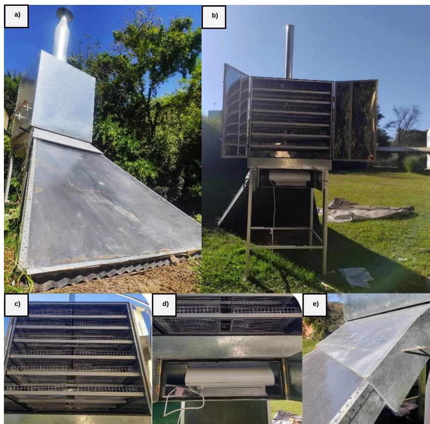
Figura 5.8. Equipo instalado para su evaluación experimental. a) Chimenea definitiva, b) Vista anterior de la cámara con detalle de la raquera y chimenea provisional, c) detalle de las bandejas, d) detalle del caloventor y e) detalle del sistema para abrir y cerrar entrada de aire.
