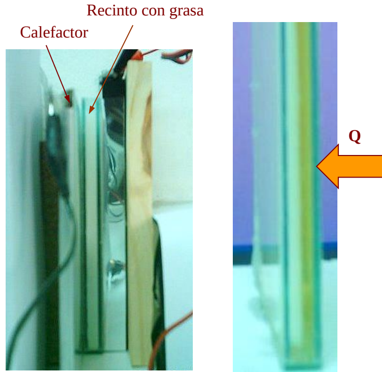
Figura 6-A1: Dispositivo en una geometría rectangular con calentamiento desde una pared lateral.
