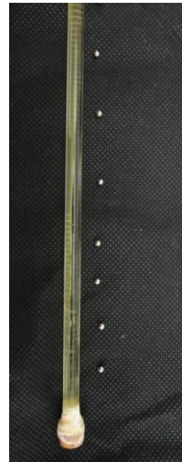
Figura 3.3. Izquierda: Esquema de la experiencia. Derecha: foto de la varilla con la sustancia ensayada y esferas de acero empleadas.
