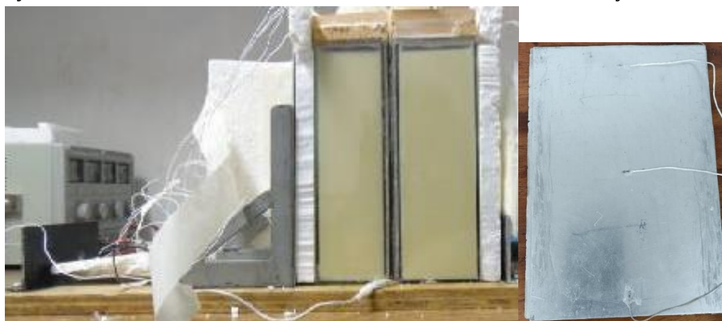
Figura 3-A3: Izquierda : Dispositivo experimental empleado en los ensayos. Derecha : Sensores de temperatura en la parte superior, centro e inferior del calefactor.
