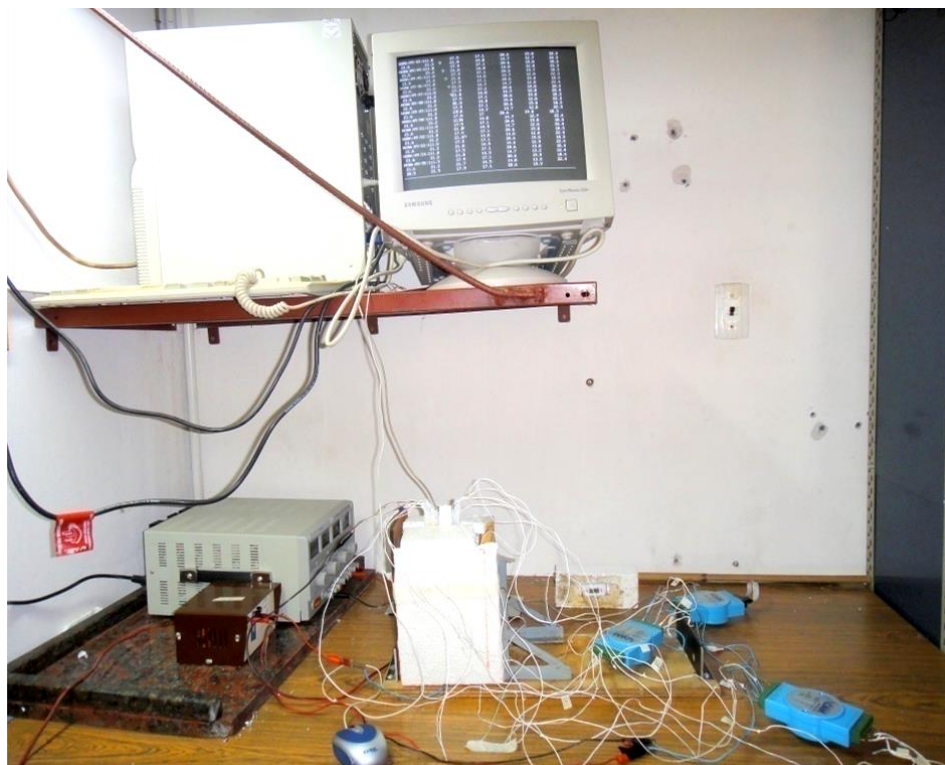
Figura 4.2: Dispositivo experimental: fuente, sensores de temperatura, registro de datos, recinto y aislación.
