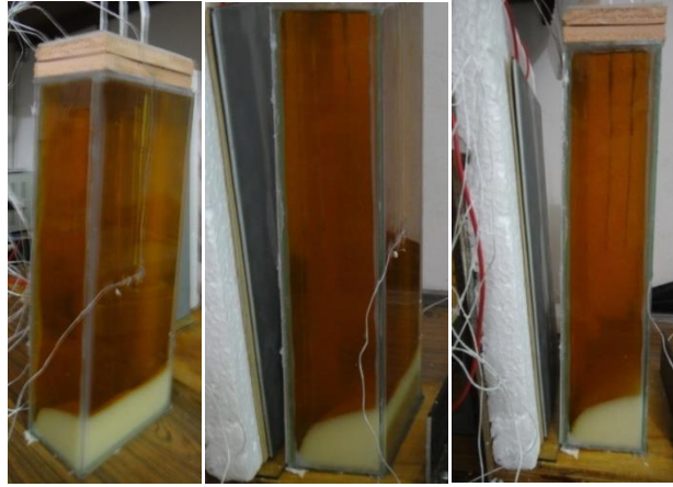
Figura 5.26: Visualización del frente de fusión en una sustancia orgánica con calentamiento lateral.
